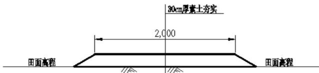
图 6-3 生产路结构图
